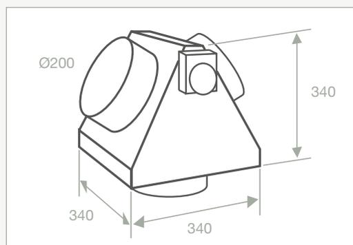
Le ByPASS automatique MyDATEC est un distributeur aéraulique 3 voies, avec 2 positions à commande électrique gérées par une commande tactile. En fonction de la température de chauffage et de rafraîchissement paramétrables indépendamment, la régulation permet le choix d'une entrée plutôt que l'autre par comparaison des températures pour assurer une optimisation de la fonction chauffage ou de la fonction rafraîchissement.
