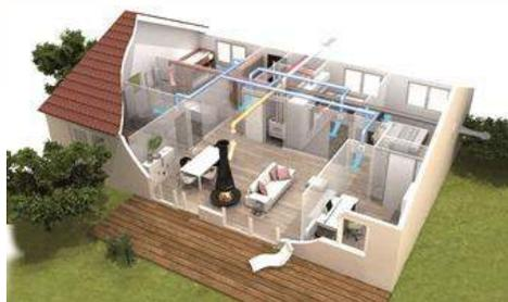
**La PME Lyonnaise, qui concentre 100% de son activité sur le développement, la fabrication, et la distribution de ses VMC thermodynamiques, investit sur une des fonctions qui fait la force de son système : le couplage de ses VMC à un poêle à bois, permettant de diffuser l'air chaud du poêle via le réseau de la VMC. Cette solution inédite amène des gains importants en termes de confort mais pas seulement. En effet, ce couplage est aussi une**
